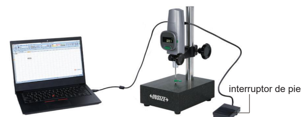
transferencia de datos a Excel sin software; presionar corto el interruptor de pie para transmitir datos, prensa larga a cero
